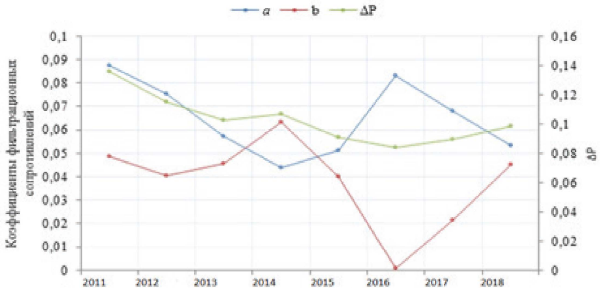
Рисунок 4 - Кривая изменения коэффициентов фильтрационного сопротивления и депрессии
