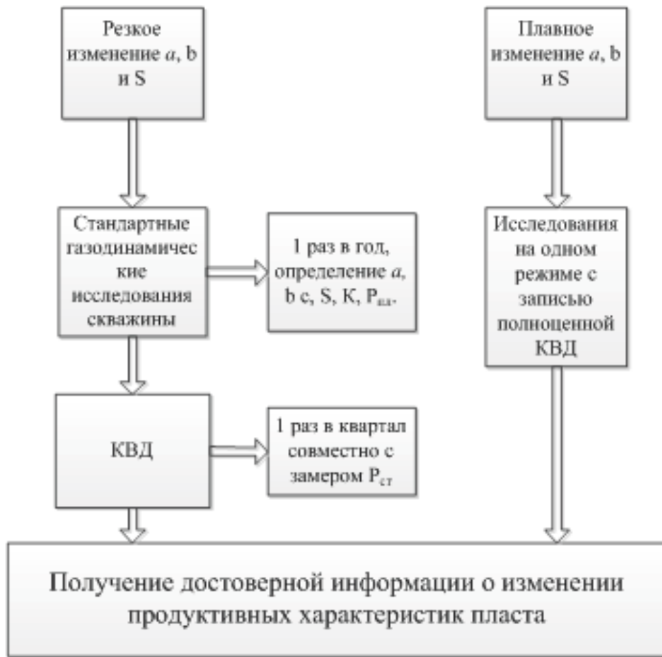
Рисунок 2 - Алгоритм оптимизации количества исследований в период постоянной добычи на газовых месторождениях
